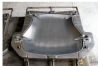
Los moldes para el asiento <5\_MY esperan capas de láminas de fibra de carbono ensambladas a mano que se convertirán en el ligero e increíblemente resistente marco de la silla.
