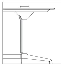
Le passe câble permet le passage des câbles à travers le plateau. Le cache-câbles se place à l'intérieur du cône, et se fixe sur le tube : il sert à maintenir et cacher les câbles. La gestion de câbles s'accroche dans la rainure sur le tube du piétement et permet de cacher l'acheminement des câbles.
