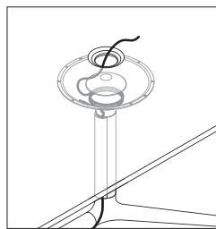
Über die Kabeldurchführung können Kabel durch die Tischplatte geführt werden. Die Innenabdeckung wird im Trichter platziert und auf dem Rohr befestigt. Sie hält und verdeckt die Kabel. Der Kabelmanager wird in der Nute am Fußrohr befestigt und verdeckt die Kabelführung.
