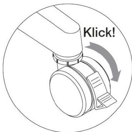
Figure 5-3 : réglage et blocage des roulettes
