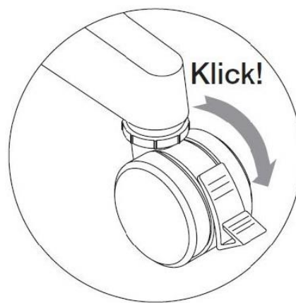
Bild 5-3: Rollen einstellen und sperren
