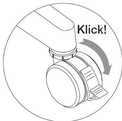
Imagen 5-3: Ajustar y bloquear los rodillos
