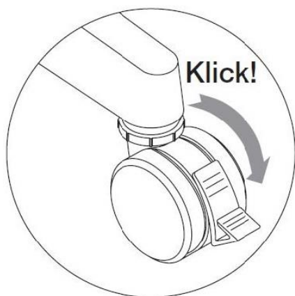
Рис.5-3. Регулировка и фиксация ролика.
