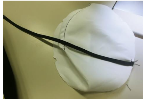
4B. Coudre une extrémité de l'élastique sur l'encoche du haut en réalisant 2 points en arrière.
