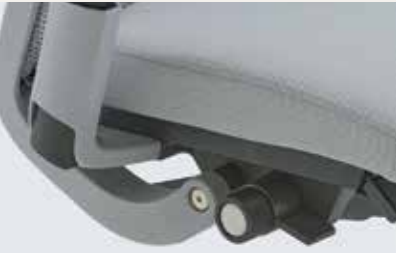
倾仰度调节 舒适度旋钮提供四种设置：直立靠背锁定、中段靠背停止、增强设置（为有需要的人提供 +20% 的额外靠背张力）和体重激活完全倾仰功能。
