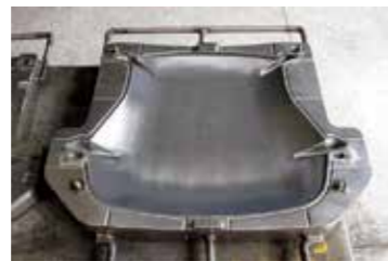
<5_MY座椅模型正准备人手安装碳纤维椅面，为座椅添上轻便而坚固无比的框架。
