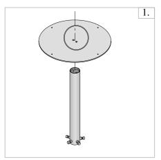
プレートと支柱をM6x30ネジでしっかりと固定してください。 Fix the plate and support securely with the M6x30 screws.
