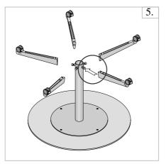
支柱にレッグをはめ込み、固定用ネジをしっかりと 締め込んでください。 Insert the legs into the support, and fix firmly in place with screws.
