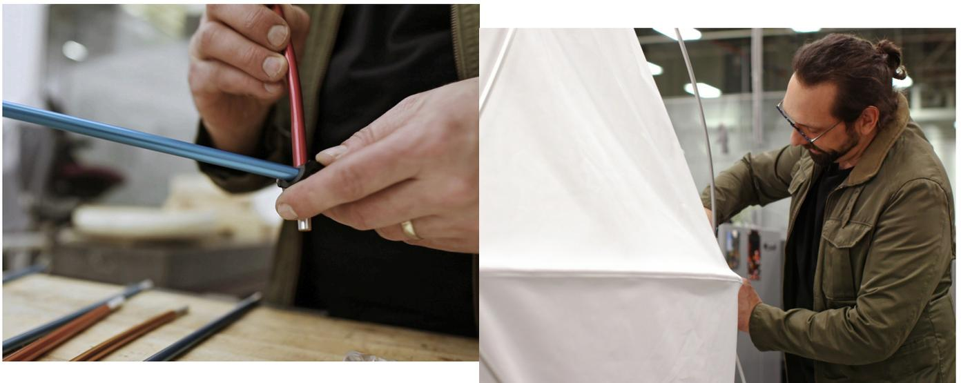
まず、チームはパイプクリーナーや弦、ダクトテープの材料だけで、迅速に簡単な試作モデルを製作した。その中で構造そのものが動くように出来ているため、カタチがどう変わるかを予測するのが非常に難しいことに気がついた。
