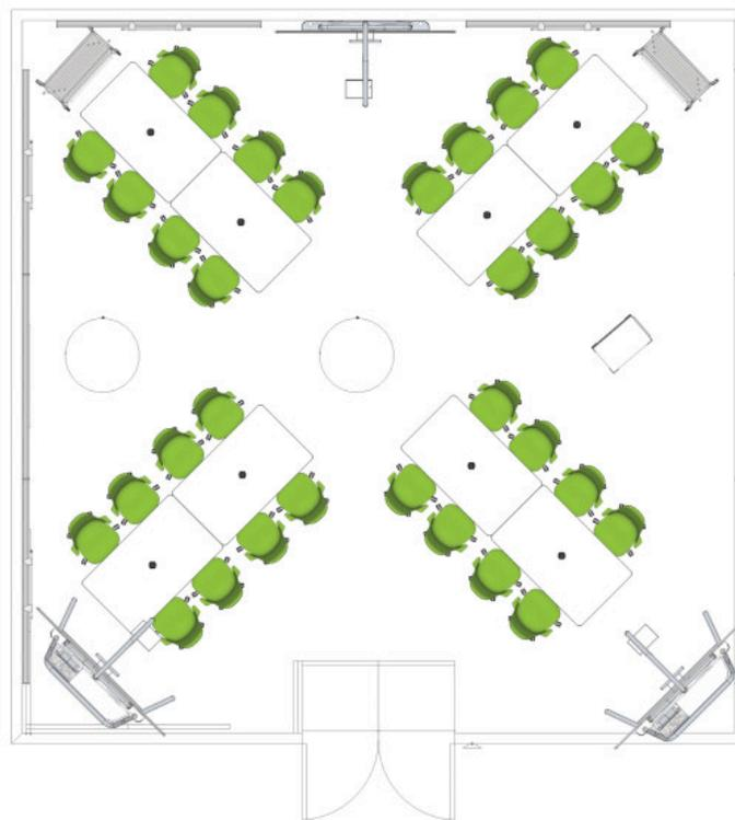
Steelcase製品を使用した独自のレイアウトが特長のLearnLabは柔軟性が高く、テクノロジーの積極的な活用を考慮した従来とは全く異なる教室です。黒板がある壇上に向けて机が並ぶレイアウトではなく、テーブルとチェアをX型レイアウトに配置することで、部屋に正面をつくらぬような工夫がされています。
